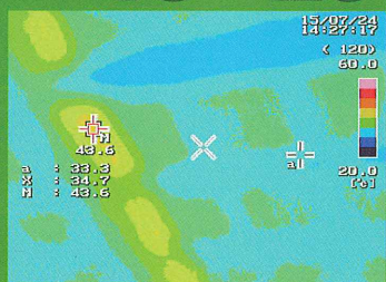
遮熱塗装部屋根の裏面温度
